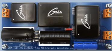
虽然集中式电源解决方案提供多个输出单元,但模块化方法通过模块组合提供相同(或更好)的性能。每个模块化解决方案的结构根据应用的不同需求,包括多个DC-DC转换器,可改变公共母线电压以满足负载需求。
